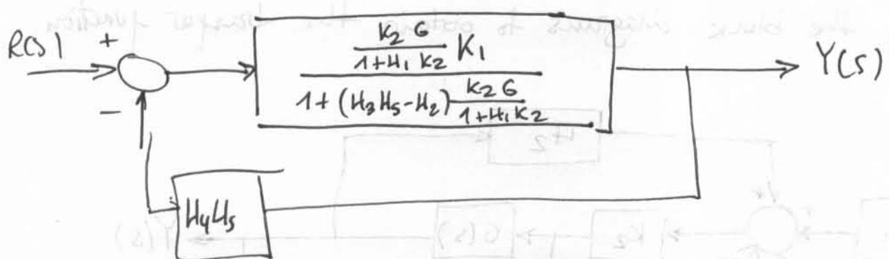
$$R(s) \rightarrow \frac{\frac{k_1 k_2 G}{1 + H_1 k_2 + k_2 G (H_3 H_5 - H_2)}}{1 + H_4 H_5 \frac{k_1 k_2 G}{1 + H_1 k_2 + k_2 G (H_3 H_5 - H_2)}} \rightarrow Y(s)$$
