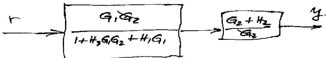
$$\frac{Y}{R} = \frac{G_1(G_2 + H_2)}{1 + H_3G_1G_2 + H_1G_1}$$
